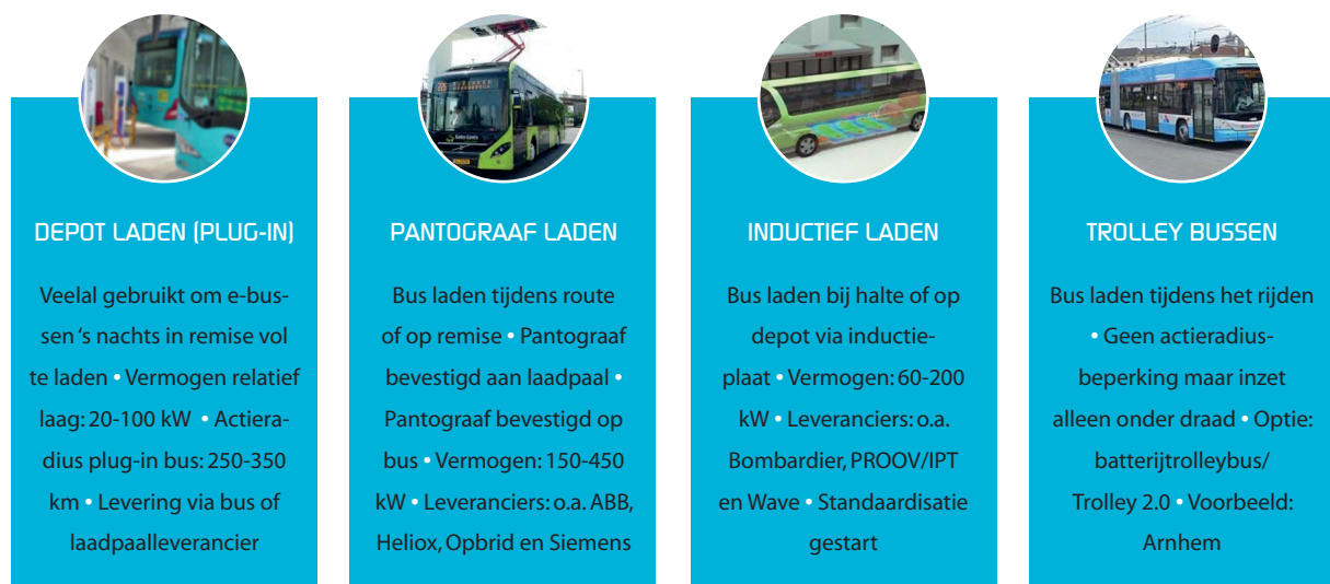
Figuur 1: Laadmogelijkheden e-bussen
